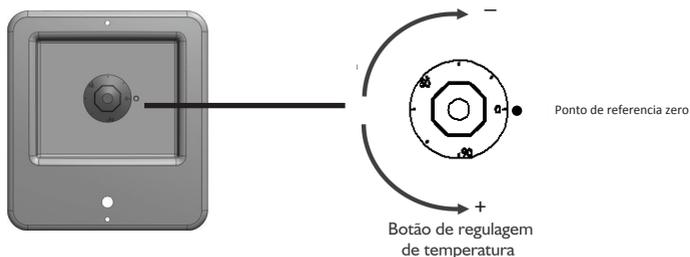
Para fazer a regulagem da temperatura do reservatório térmico através do botão, basta girar no sentido horário (+) para aumentar a temperatura e no sentido antihorário (-) para diminuir a temperatura.
