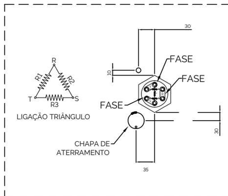
Esquema de ligação TRIÂNGULO - Utilizado em regiões com tensão de alimentação em 220V trifásico (127V monofásico).
