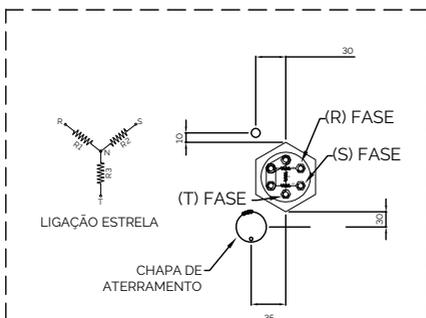
Esquema de ligação ESTRELA - utilizado em regiões com tensão de alimentação em 380V Trifásico.
