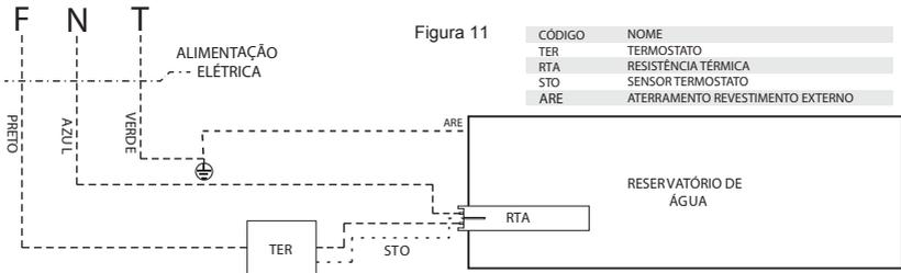
É obrigatório a ligação do fio de terra ao sistema de aterramento. O aterramento do revestimento externo (alumínio) deverá ser realizado na região indicada com o adesivo.
