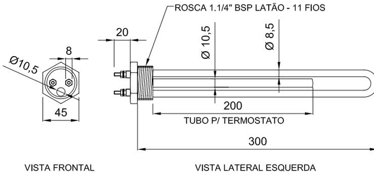
Existe a possibilidade de ligar o resistor na tensão em 127V (monofásico), porém a potência a ser dissipada será inferior, de aproximadamente ~1000W e ~1666W respectivamente.
