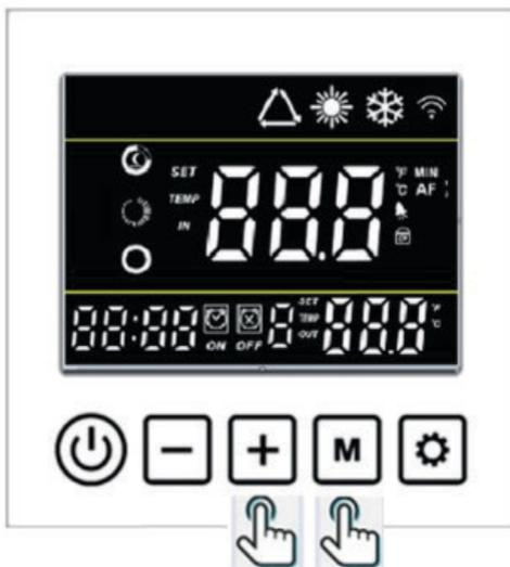
O indicador Wi-Fi piscando é uma sinalização que o dispositivo está pronto para ser configurado. Retorne à tela do celular.
