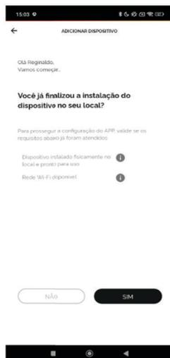
**Observação:** O smartphone deve estar conectado à rede Wi-Fi 2,4 GHz e, obrigatoriamente deve ser a mesma rede Wi-Fi que será usada para conectar à Bomba de Calor.
