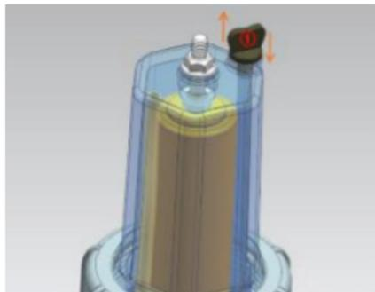
3) A seguir, conecte o condutor de cobre fornecido com o dispositivo no parafuso fixado no topo, conforme imagem abaixo;
