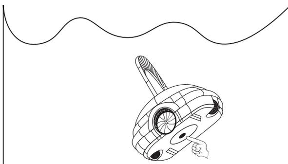
Depois de acionar o botão para ligar, solte-o; ele vai submergir lentamente, e após 5 segundos, ele começa o processo de aspiração.
