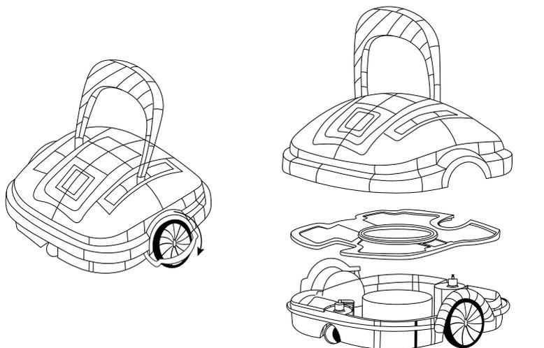
2) Retire a malha filtrante e lave com água corrente; se necessário, utilize detergente neutro.
