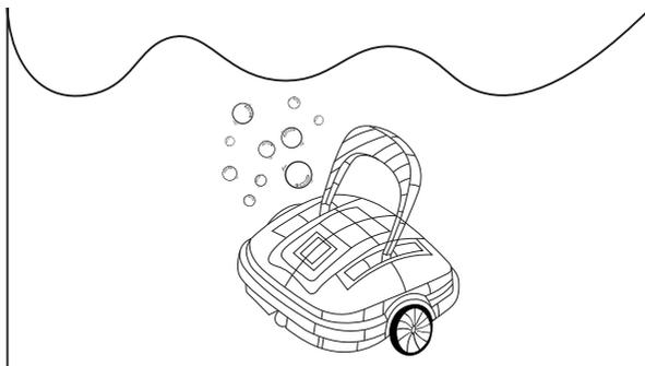
Mantenha-o submerso por um breve instante; em seguida, pressione o botão na parte inferior para ligar o Robô. Neste momento, o Robô pode continuar submerso.
