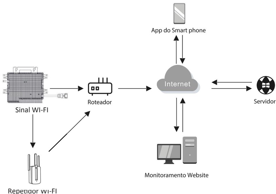
**OBS:** Se o sinal wireless na área onde o microinversor está instalado for fraco, é necessário adicionar um amplificador de sinal wifi em local adequado entre o roteador e o microinversor.
