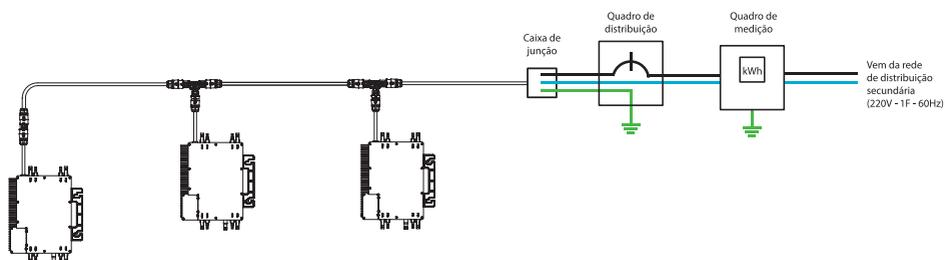
**ATENÇÃO:** O código de cores da fiação pode ser diferente de acordo com a regulamentação local. Verifique todos os fios da instalação antes de conectar ao cabo CA para ter certeza de que correspondem. Cabeamento incorreto pode danificar irreparavelmente os microinversores, tal problema não é coberto pela garantia.
