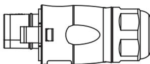
Após fixação do inversor na estrutura deve ser realizado a montagem do conector macho CA.
